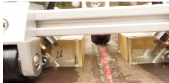
Фиг. 5. Сканираща система по метода фазова решетка на челно заварено съединение - планка, произведена в Мултитест ООД
